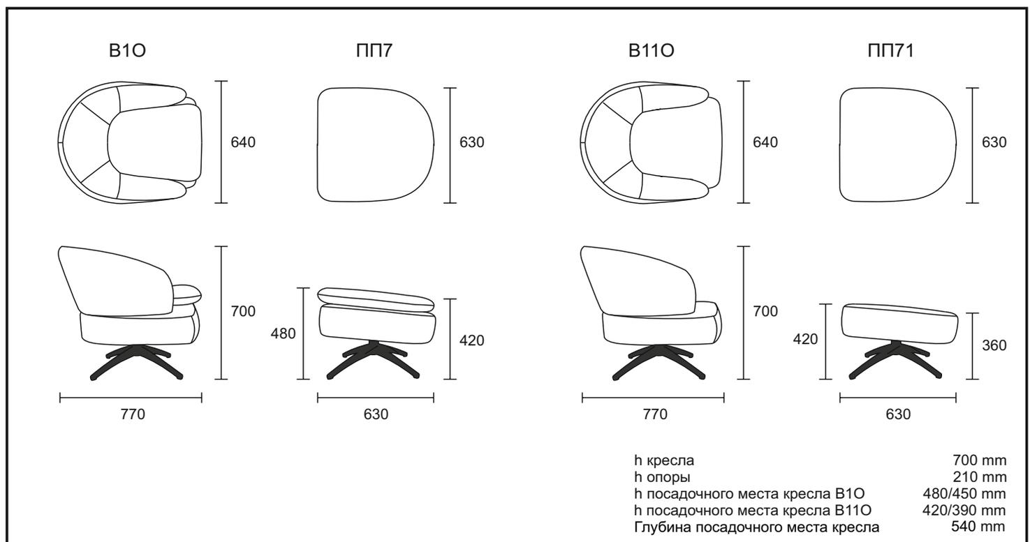
Согласно ГОСТ 19917-2014: для мебели, габаритные размеры которой определяются размерами мягкого элемента, предельные отклонения от габаритных размеров не должны превышать +/- 20мм.
