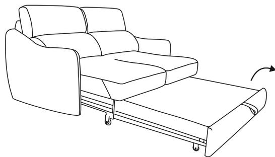
Выкатить спальный блок вместе с сиденьем до упора, за переднюю планку. С помощью петли перевести блок в верхнее положение.
